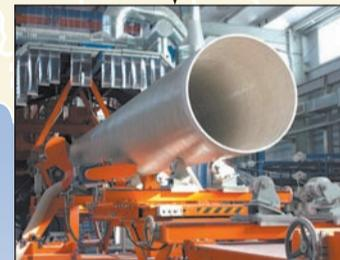
Открыли серийное производство первых в мире стеклопластиковых труб с одностенными нанотрубками. В мире аналогов такого продукта нет. Их использование снижает риск возникновения ЧП.
