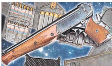
Оружие выживания космонавтов: охотничий неавтоматический трёхствольный пистолет ТП-82. Фото worldweapon.info/tp-82
