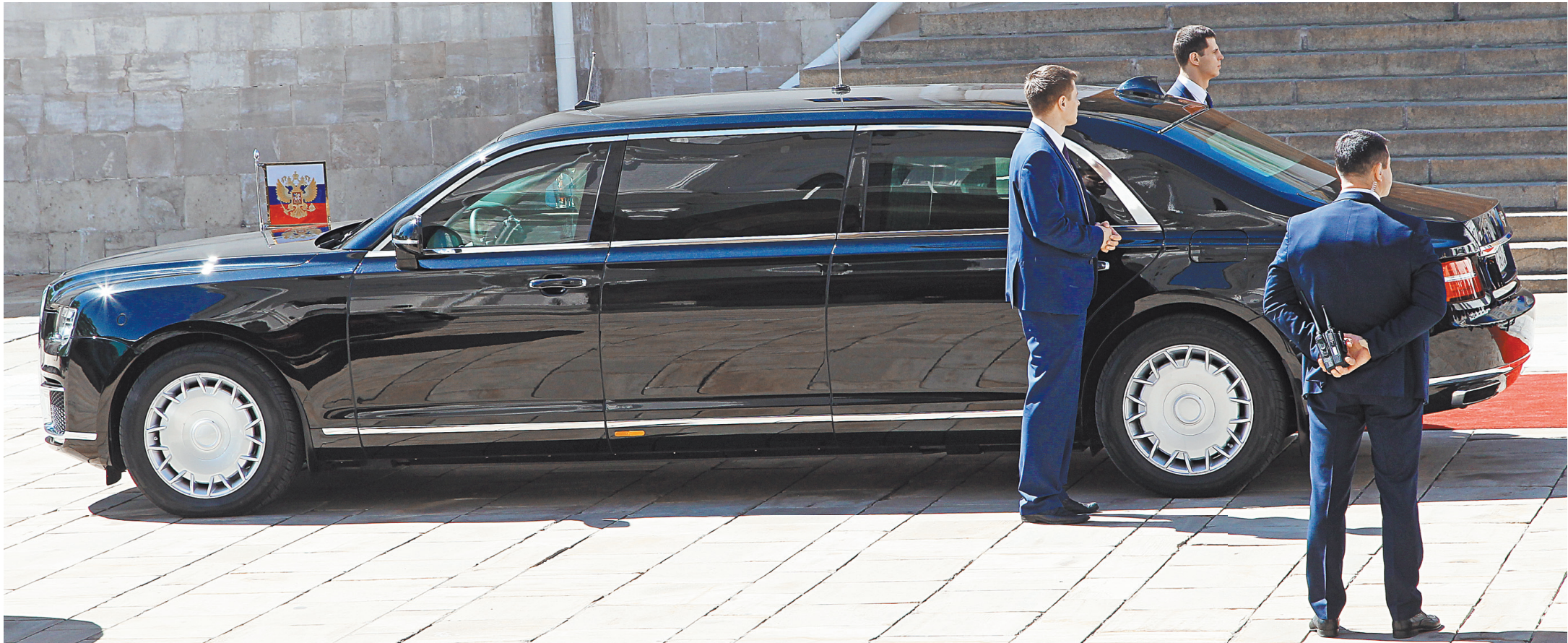
В длину президентский лимузин достигает 6620 мм, в ширину — 2000 мм, а клиренс как у внедорожника — 200 мм. Эта версия бронированная и весит 6,5 тонны.
