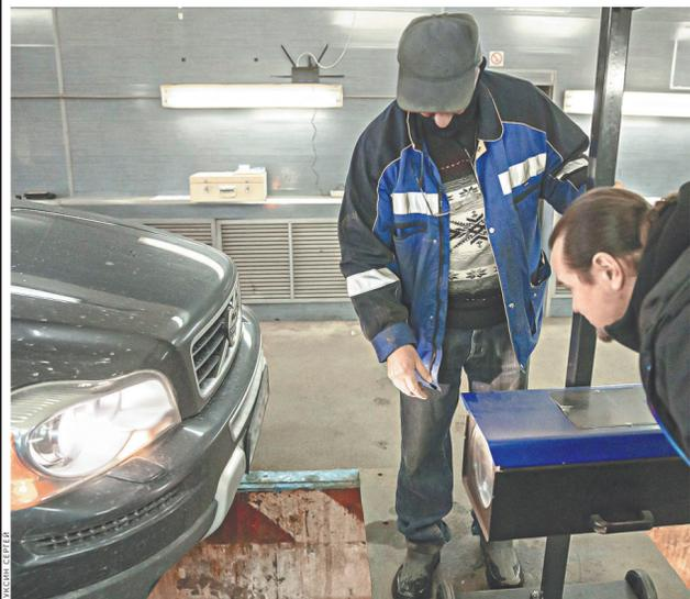
Регулировка фар проверяется специальным прибором.
