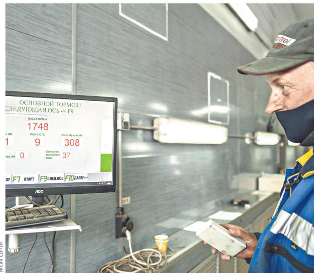
Разница удельной тормозной силы на колесах одной оси не должна превышать 20.
